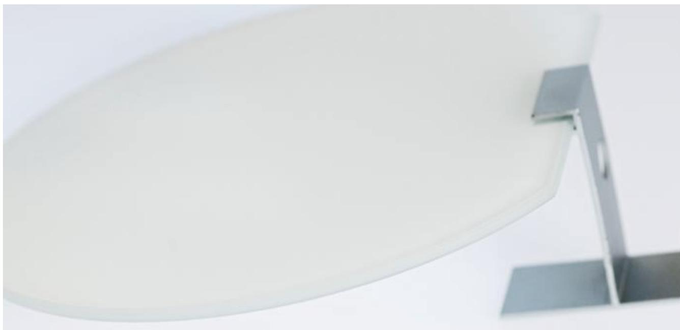
Wenn die mechanische Festigkeit von Glas für den geplanten Einsatz wesentlich erhöht werden muss, kommt das chemisch vorgespannte Glas **Sichem** zum Einsatz. Hier erfolgt die Vorspannung durch Ionenaustausch, wodurch ein 5-fach höherer Festigkeitswert im Vergleich zu nicht vorgespanntem Glas erzielt wird.
